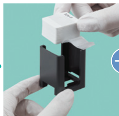
Поставете панела в касетката и отстранете свързващата лента
